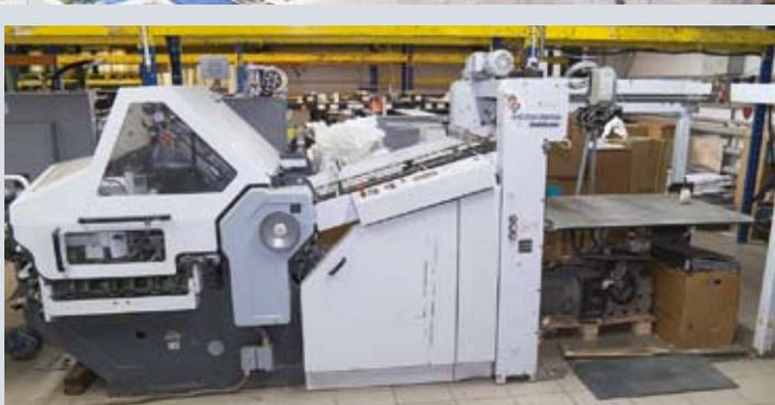
Часть комплекса послепечатного оборудования для производства журнальной продукции: листоподборочная линия, машина для клеевого бесшвейного скрепления, фальцевальная машина
