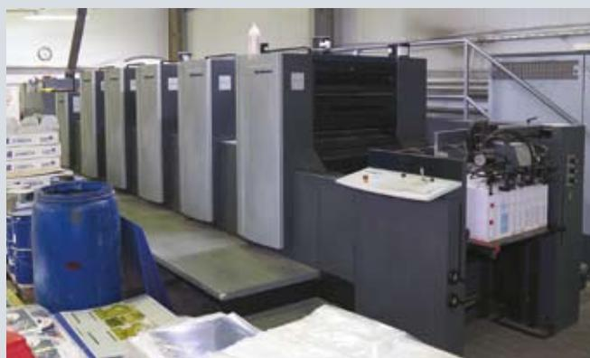
Печатный парк типографии Forte Press представлен как полуформатными машинами, так и оборудованием первого формата. На пятикрасочной Heidelberg Speedmaster 74, оснащенной секцией лакирования и УФ-сушкой для работы с высокореактивными УФ-красками и лаками (на фото справа), здесь изготавливают обложки журналов, а в перспективе — упаковочную продукцию
