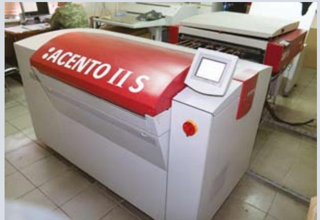
Допечатный участок по выводу форм представлен термальными устройствами CtP от компании Agfa. Наличие двух систем позволяет дублировать формный процесс
