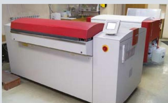
Основу допечатного цеха типографии «Дитон» составляет CTP-устройство Agfa. Печатные формы выводятся на термальных пластинах Fujifilm CT-M, поставляемых компанией «ЯМ Интернешнл». За счет чуть более тонкой алюминиевой основы эти пластины оказываются экономически выгоднее
