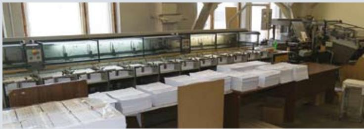
Цех послепечатной обработки оттисков укомплектован специализированным оборудованием, в частности горизонтальной и вертикальной листоподборочными линиями, фальцевальной машиной и т. д.
