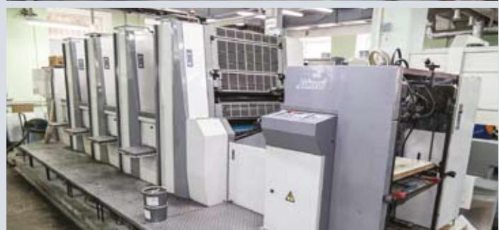
На производственной площадке «Подольской Фабрики Офсетной Печати» работают три офсетные машины японской компании Sakurai в четырех- и пятикрасочном исполнении, позволяющие выпускать многополосную печатную продукцию. Кроме того, здесь установлена и рулонная четырехкрасочная машина Mark-62, которая используется для печати сборников сканвордов
