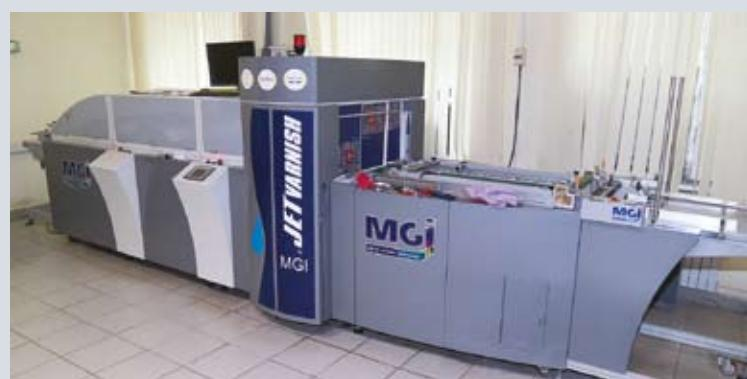
Слева на фото: цифровая машина для выборочного УФ-лакирования JETvarnish. Основное ее преимущество в том, что для лакирования не требуется печатных форм или трафаретных сеток, а также не нужно время для приладки и выхода на тираж. Справа: цифровая печатная машина MGI Meteor DP 60 позволяет работать на мелованных, дизайнерских фактурных материалах, пластиках. Оснащена опцией печати на различных конвертах и баннерах
