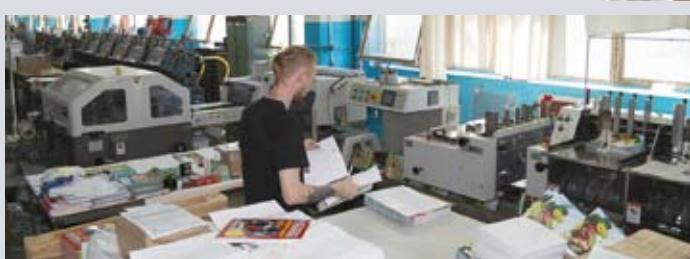
На комбинате большое внимание уделяется оснащению послепечатного парка оборудования. Сегодня на предприятии работают несколько вкладочно-швейно-резальных линий, оборудование для подборки и kleевого скрепления блоков, в том числе современная линия Kolbus
