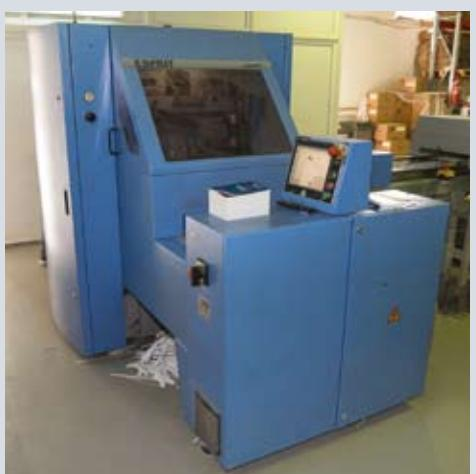
В целях модернизации предприятия была закуплена новая автоматизированная линия клеевого бесшвейного скрепления Muller Martini Pantera с большим количеством подборочных станций. Оборудование позволило улучшить качество склейки и существенно повысить производительность при выполнении заказов на изготовление изданий в мягком переплете
