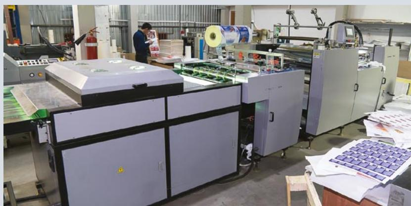
Промышленный ламинатор, оснащенный УФ-лампами, для получения более качественной припрессовки пленки. На нем апробируются пленки, которые завозят компания Lamstore из Китая, а также выполняются заказы на ламинацию
