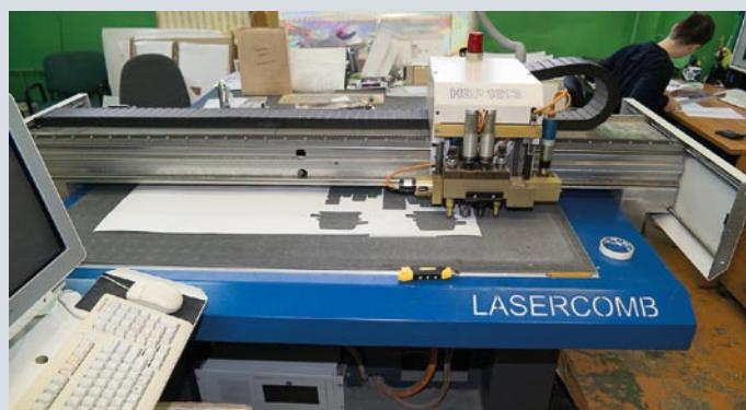
Режущий плоттер для вырезания образцов будущих коробок.
