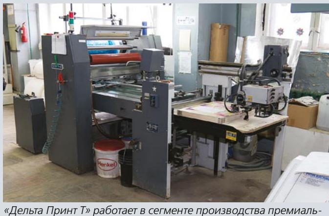
«Дельта Принт Т» работает в сегменте производства премиальной упаковки из металлизированного картона. Материал для печати здесь ламинируют на собственном оборудовании
