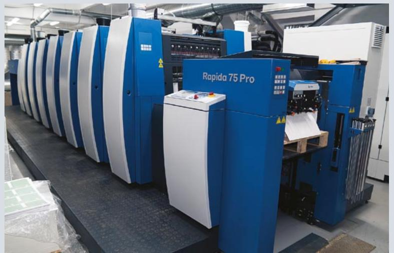
В типографии «Дельта Принт Т» запущена в работу первая в России печатная машина Koenig&Bauer Rapida 75 Pro в шестикрасочном исполнении, оснащенная секцией лакирования и УФ-сушильными устройствами. Оборудование снабжено системой индикации красочных зон и основных параметров печати, что позволяет получать оттиск высокого качества. Кроме того, с помощью камеры с обратной связью выполняется точное измерение кроющихся белил и контроль плотностей
